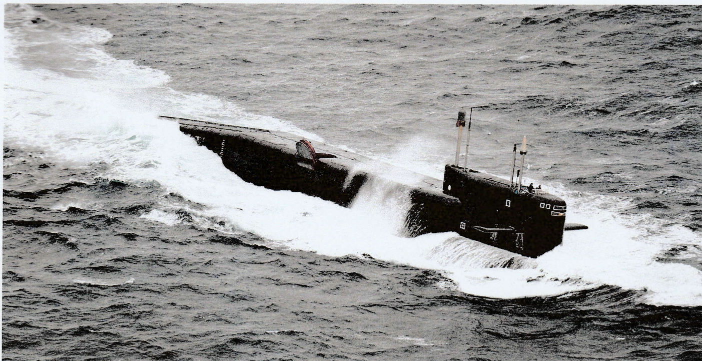
Bastionforsvaret er ikke noe helt nytt. Sovjet/Russland har alltid ønsket å beskytte sin «atomtriade» i nord. Delta IV-klasse er den nyeste russiske ubåttypen. Fartøyet kan ta 16 ballistiske missiler som alle kan avfyres på samme tid under fart og i undervannsstilling. (Foto: Forsvaret)
